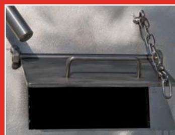
Escotilla acoplada a la puerta frontal que permite regular la entrada de aire al horno.
